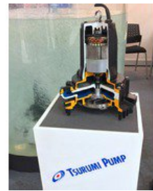
Attraktion auf der BrauBeviale 2015: Ein TRN-Tauchbelüfter von Tsurumi zur biologischen Abwasserklärung, vorn als Schnittmodell, dahinter beeindruckend in Betrieb im Wasserbassin (Foto: Tsurumi) Download Foto
